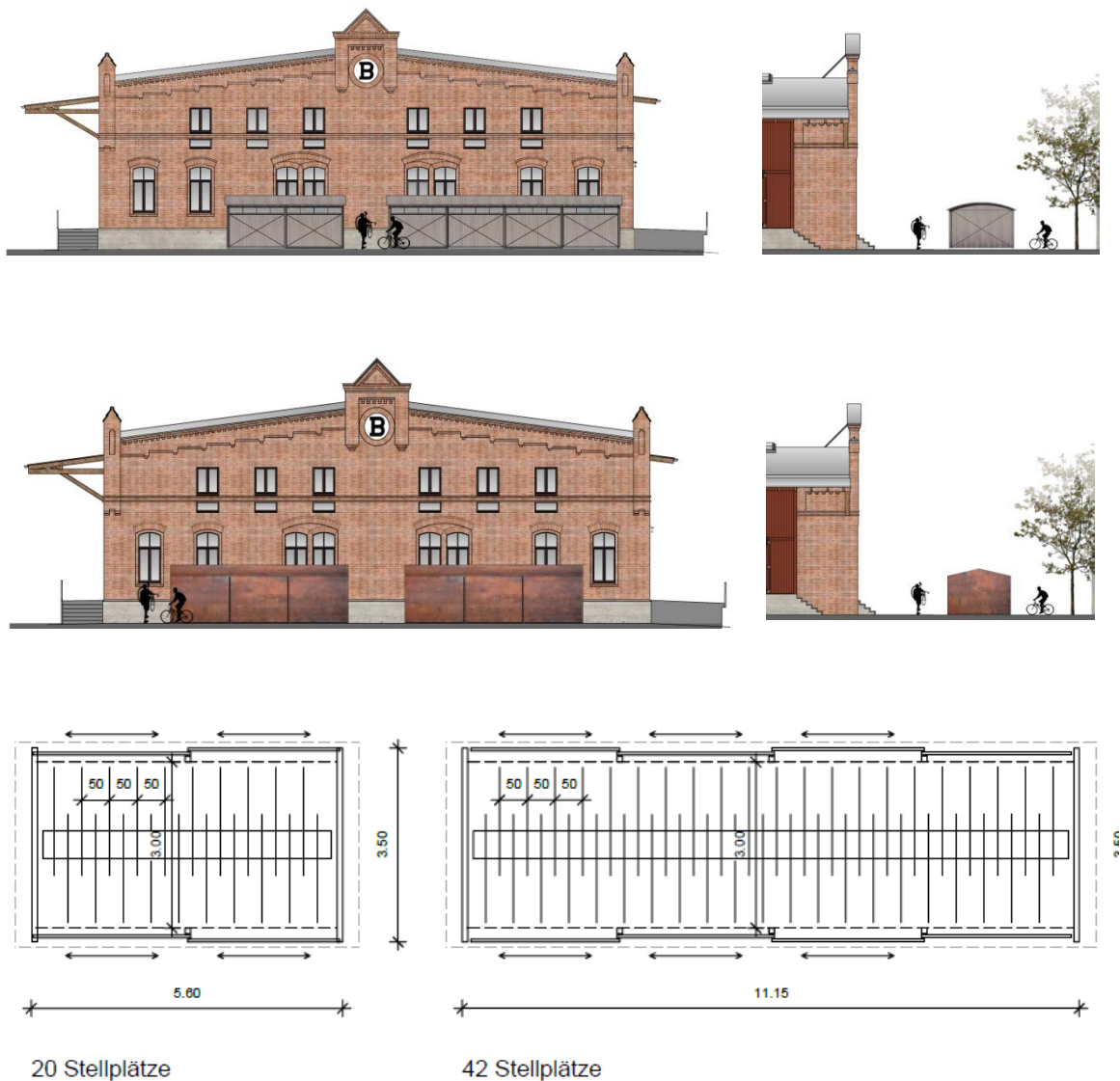
Abb. 4 o.M. Gestalterische Vorgabe für die Realisierung von Fahrradschuppen. (Quelle: Riemann Gesellschaft von Architekten)
